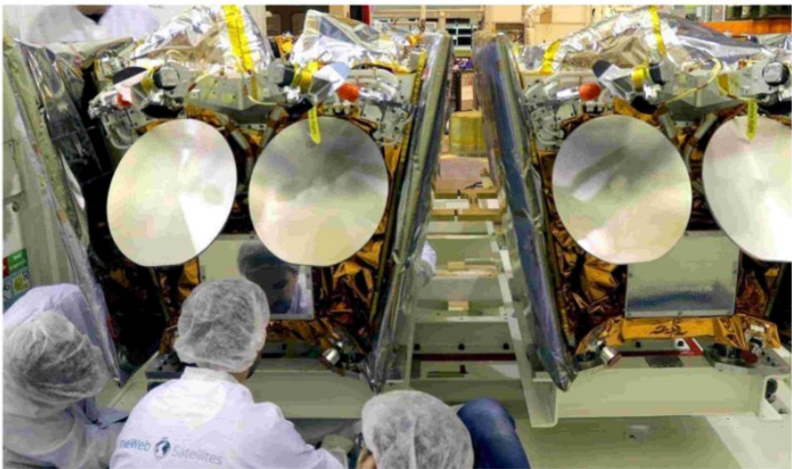
Réseau satellite dans l'usine de Toulouse : deux Oneweb Earth Trabunals sont montés sur la plateforme d'un conteneur Fradu.
